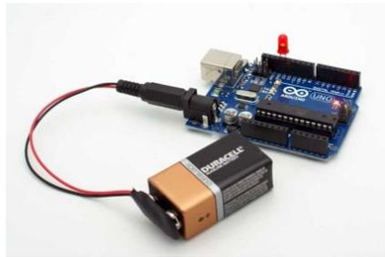
Conexión recomendada de la tensión de alimentación a la placa de prototipos.
