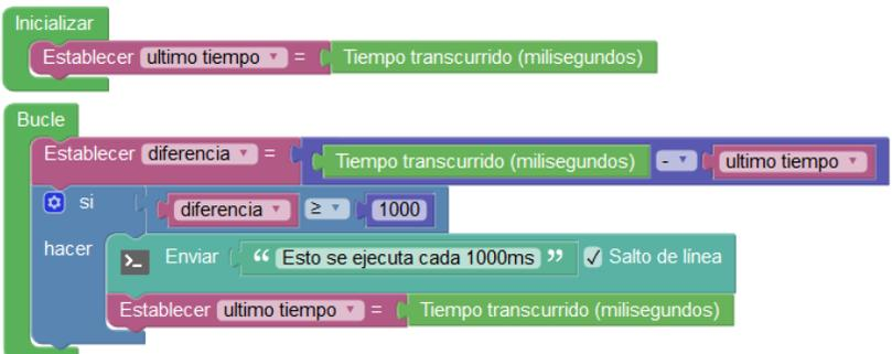
Cuando necesitemos realizar distintas tareas periódicas y que parezca que se ejecuten paralelamente sin bloquearse unas a otras utilizaremos este tipo de bloque "ejecutar cada".
