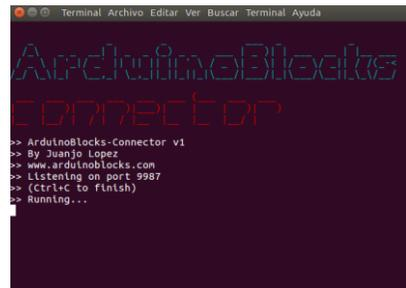
*ArduinoBlocks-Connector* debe ejecutarse en el equipo donde está conectado Arduino físicamente (por conexión USB). La configuración normal es instalar *ArduinoBlocks-Connector* en el mismo equipo donde se trabaja con ArduinoBlocks.
