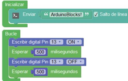
**Importante:** El "bootloader" de Arduino normalmente tiene configurada la opción de resetear el microcontrolador cuando se inicia una conexión serie, por tanto si conectamos con la consola serie del PC hay que tener en cuenta que se reiniciará el programa y se ejecutará el bloque "inicializar"
