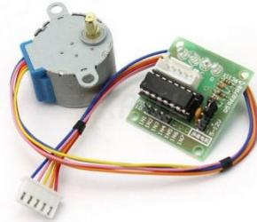
Para controlar un motor paso a paso utilizamos un módulo capaz de controlar cada una de las 4 señales de control que activan cada bobina. Realizando la secuencia correcta movemos el motor, según el número de pasos y velocidad a la que avanzamos en la secuencia. Todo esto se realiza internamente automáticamente.
