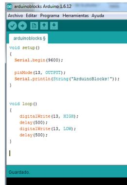
Si descargamos o copiamos el código generado por ArduinoBlocks en Arduino IDE podemos necesitar algunas librerías no incluidas con Arduino IDE. Para ello debemos descargarla y añadirlas a la plataforma Arduino IDE para una correcta compilación del programa, o utilizar la opción descargar .zip para Arduino IDE lo que nos facilitará un archivo comprimido con el código de nuestro programa y todas las librerías necesarias incluidas en la misma carpeta.
