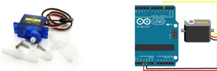
El control de la posición de un servomotor se realiza mediante PWM por lo que necesitamos conectarlo a una salida digital de tipo PWM.
