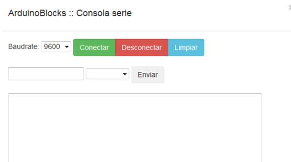
A la hora de establecer una conexión serie los dos extremos que intervienen en la conexión (en este caso Arduino y el PC) deben establecer el mismo valor en la velocidad de la conexión.
