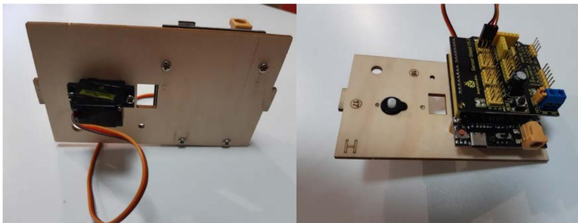
Para terminar de completar esta pieza vamos a necesitar el zumbador el cual se encuentra en la caja de accesorios. Lo instalaremos en la parte superior de la pieza, justo al lado del controlador con un tornillo M3\*10MM,
