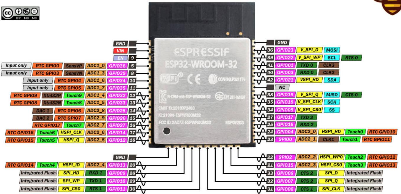
En la placa ESP32 STEAMakers, a parte de la conexiones propias del formato Arduino, tenemos los pines accesibles junto a GND y VCC de la forma standard:
